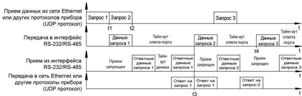
Рисунок 4.7 – Диаграмма работы прибора в режиме «запрос – ответ»
